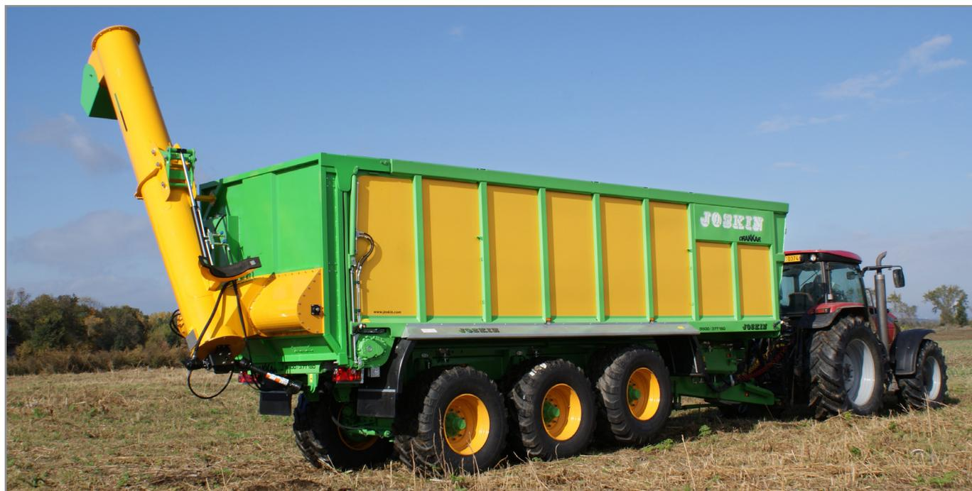
*DRAKKAR avec vis de transbordement et système de pesage dynamique permettant, lors du déchargement dans un semi-remorque, de respecter les réglementations en vigueur.*
